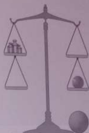
Rys. 8.7. Inną metodę pomiaru stałej grawitacji zastosował w 1880 r. Philipp von Jolly. Użył on wagi z podwójnymi szalkami.
