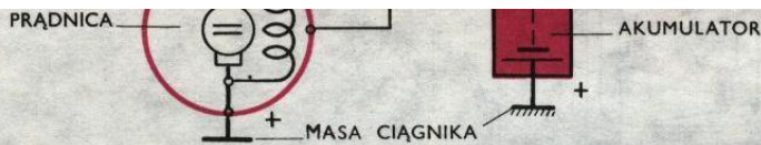
Rys. 9.9. Schemat połączeń dwurdzeniowego regulatora napięcia stosowanego w ciągnikach Ursus C335
