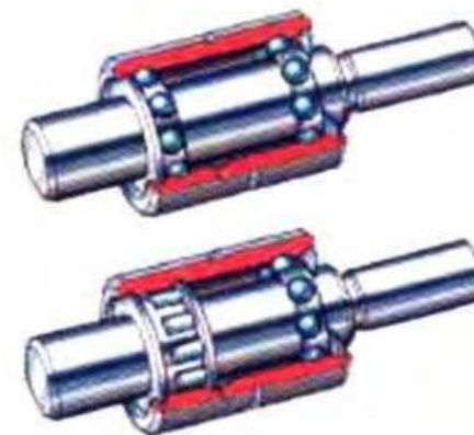
Trzpień obrotowy z dwoma łożyskami kulkowymi (u góry) i z łożyskiem kulkowym oraz wałeczkowym (u dołu)
