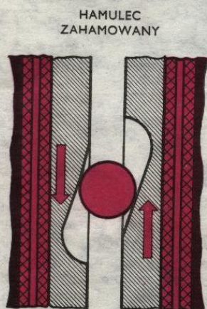
Rys. 13.6. Zasada działania hamulca tarczowego suchego w ciągnikach ciężkich Ursus
