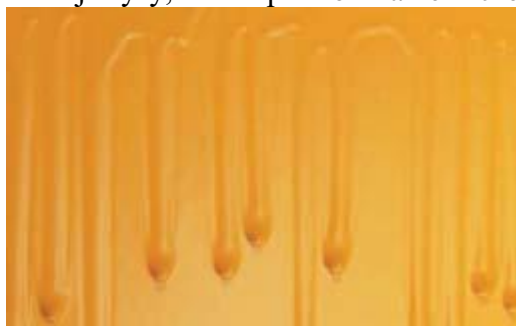
Zacieki na powłoce lakierniczej
