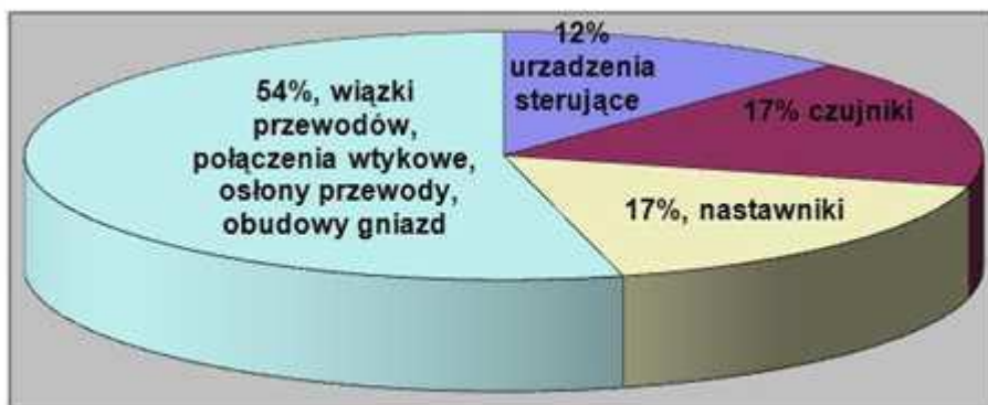
Rys. 1 Procentowe określenie awaryjności komponentów układów elektronicznych w samochodzie
